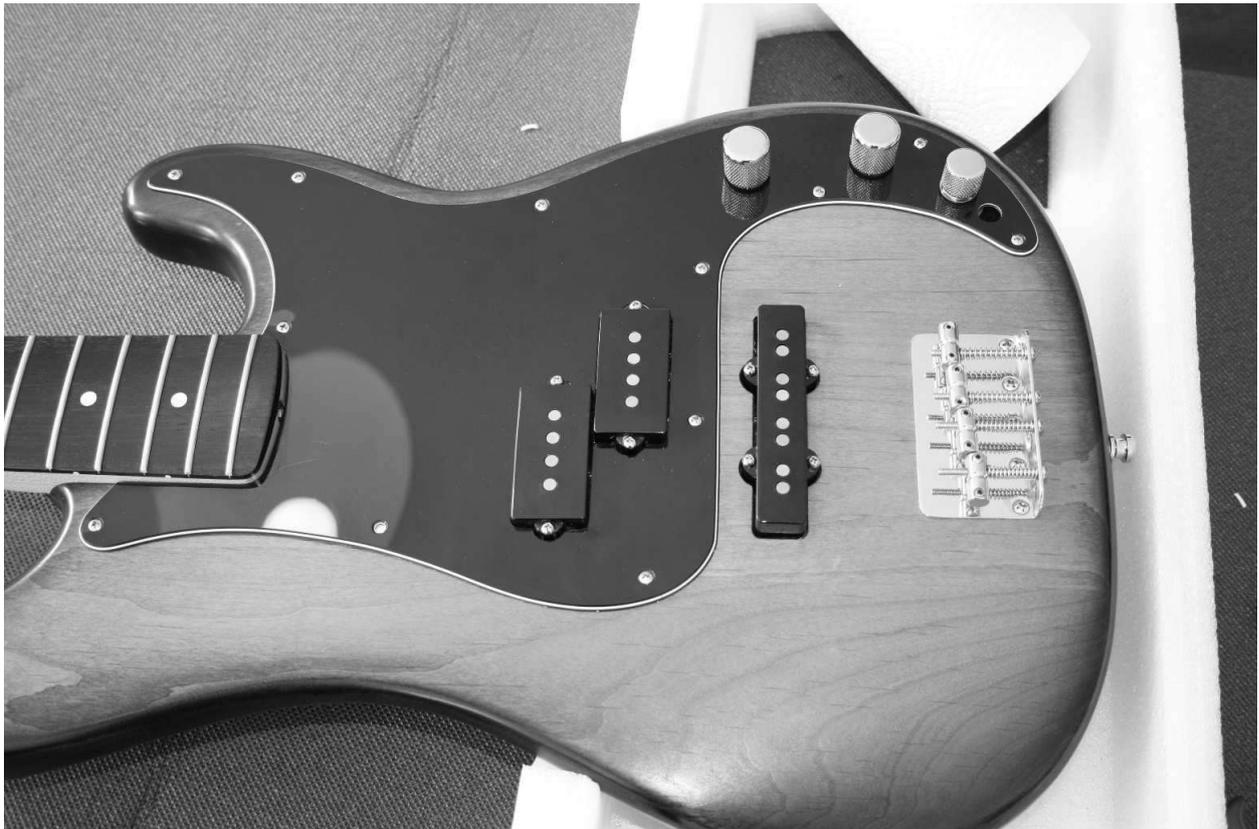
Ein erster test in unserem Proberaum ergab, dass der Bass nun nicht mehr dieses leichte „rauschen“ und „knistern“ wie vorher hat. Selbst bei eingeschalteter Deckenbeleuchtung (Neonröhren) blieb der Bass ohne Einstreuungsgeräusche. Durch den neuen Kondensator ist die Tonblende nun viel wirksamer und der Ton des Basses ist insgesamt ein wenig „frischer“ und bei leicht zugedrehter Tonblende nicht mehr so „mumpfig“.
